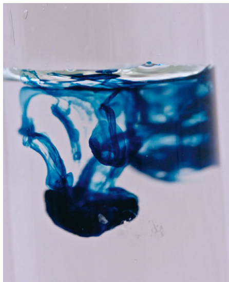
Järn(III)nitrat och kaliumhexacyanoferrat(III) ger en fällning av berlinerblått.
