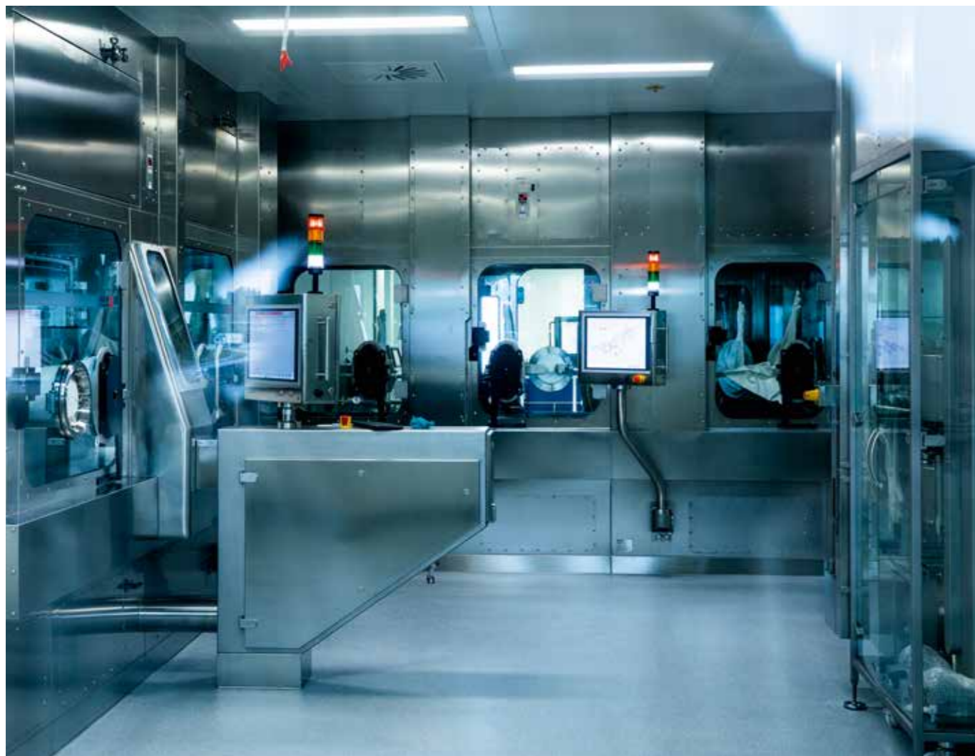
Rummet där läkemedlet ska fyllas i sprutor eller flaskor har en hermetiskt tillsluten utrustning. Här råder högsta renrumsklassen.
