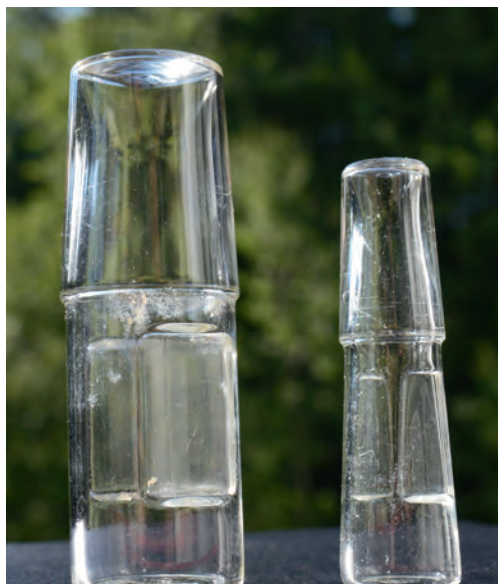
Glasproppar utan slipning som använts vid hantering av till exempel diazometan. Den skrovliga ytan hos en slipning kan nämligen vara tillräckligt för att initiera en explosion!
