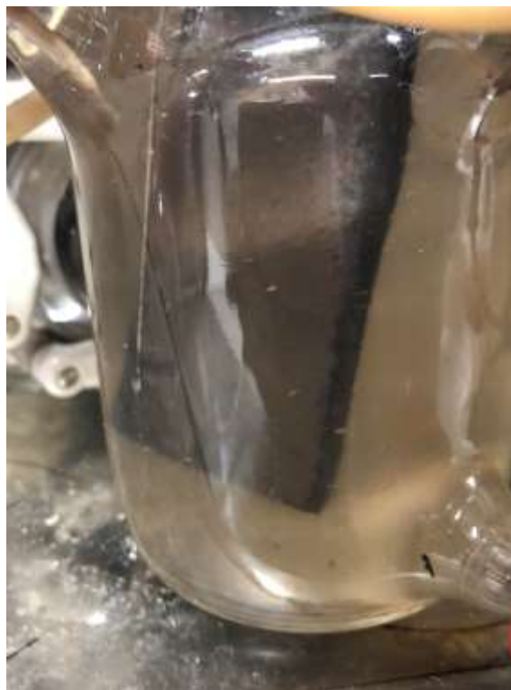
Figur 16. En bild av anodflaskan efter att bakterierna fått 20 dagar att föröka sig. På kolskum anoden syns svagt en biofilm av bakterier.
