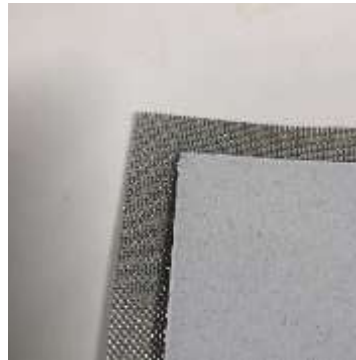
Figur 10. Den andra sidan av luftkatoden som har uppgiften att samla syre som kan reagera med elektronerna och protonerna. Det vita är ett pulver av teflon som applicerats på elektroden i flera lager. (Författaren)
