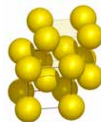
ENKEL KRISTALLSTRUKTUR – rymdcentrerad kubisk struktur, som till exempel i övergångsmetallen niob.
