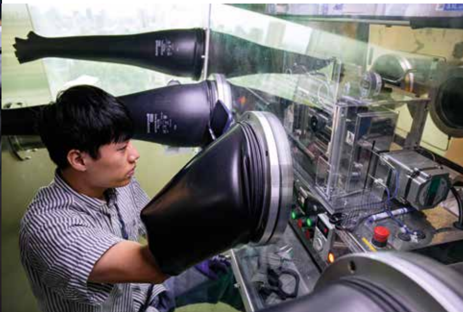
Jia-Min Ke monterar batterierna i en handsbox, för att undvika att fukt och syre tränger in och reagerar med elektrolyt eller elektroder.
